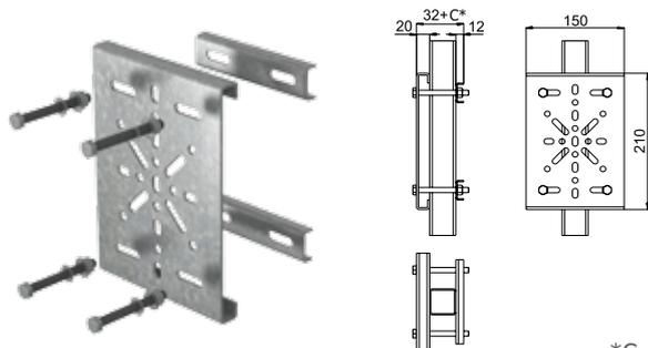
\*С - размер опоры ограждения 40-60 мм
