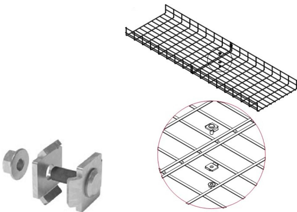
Рис.21 Соединение проволочных лотков винтовыми комплектами СПЛД20
