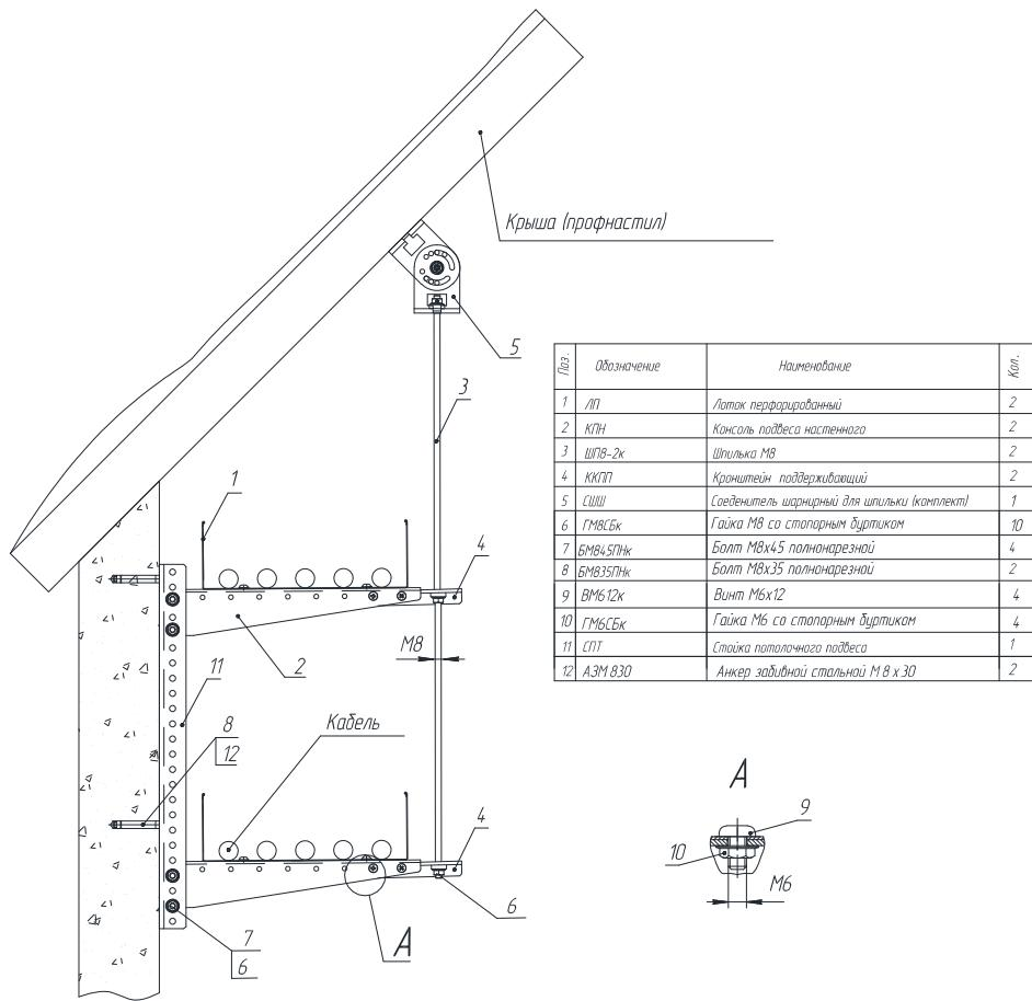
Рис.15 Крепление ОКЛ под углом к металлоконструкции (профнастилу) с помощью шарнирного соединителя СШШ
