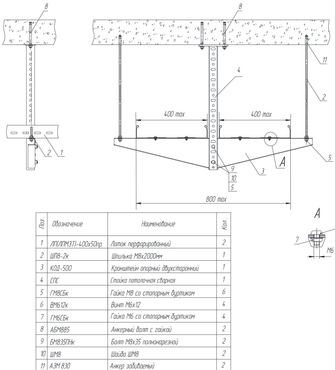
Рис.11 Пример крепления группы лотков на одной опоре
